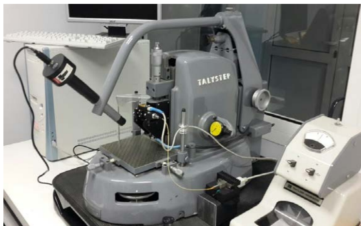
Рисунок 3. Внешний вид модернизированного прецизионного контактного профилометра нанометрового диапазона Talystep (рис.4) - в диапазоне 1,0 – 3000 мкм - модернизированного контактного широкодиапазонного профилометра Form TalySurf (рис.4)
