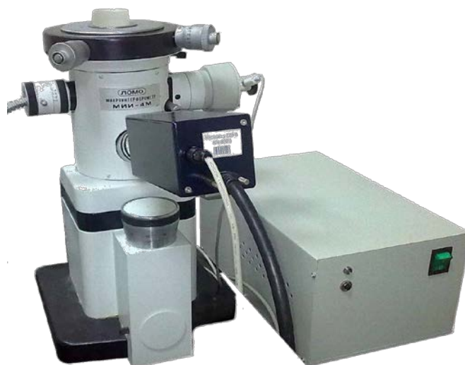
Рисунок 2. Внешний вид модернизированного автоматизированного интерференционного микроскопа МИА-М1
